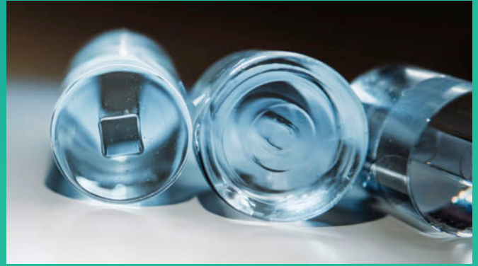
Glasfaser-Rohlinge mit rechteckiger und runder Kerngeometrie im Vergleich
