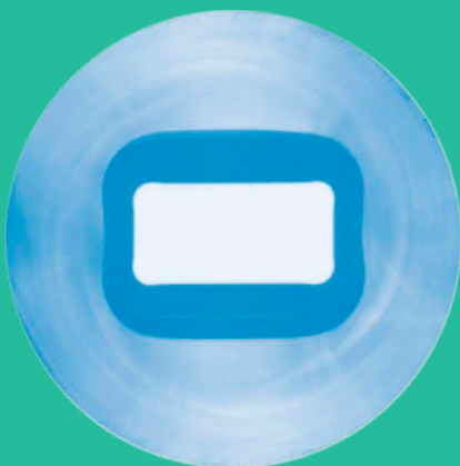
Querschnitt einer Optran-NCC-Faser mit rechteckiger Kerngeometrie
