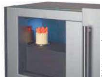
Der Tomoscope XS FOV 500 misst mehrere Werkstücke in einem Arbeitsgang
